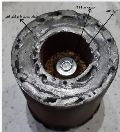
شکل شماره (3) : نمایی از چشمه، دانه و شیلد سربی
