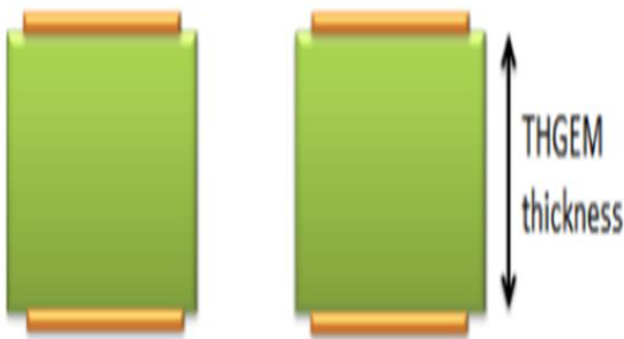
شکل ۲: نمونه ای از ساختار THGEM [13]
