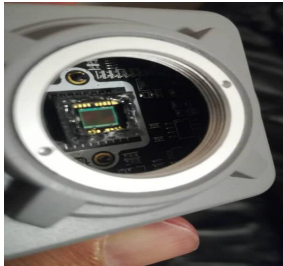
شکل (۲): CCD بدون لایه محافظ
